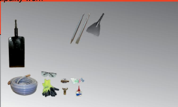
Dieses Kofferset eignet sich für umfassende Arbeiten im kommunalen Bereich. Der Schwerpunkt liegt auf Erdarbeiten. Die Meisselauswahl ermöglicht das Arbeiten in schweren Böden und bei harten Oberflächen.
