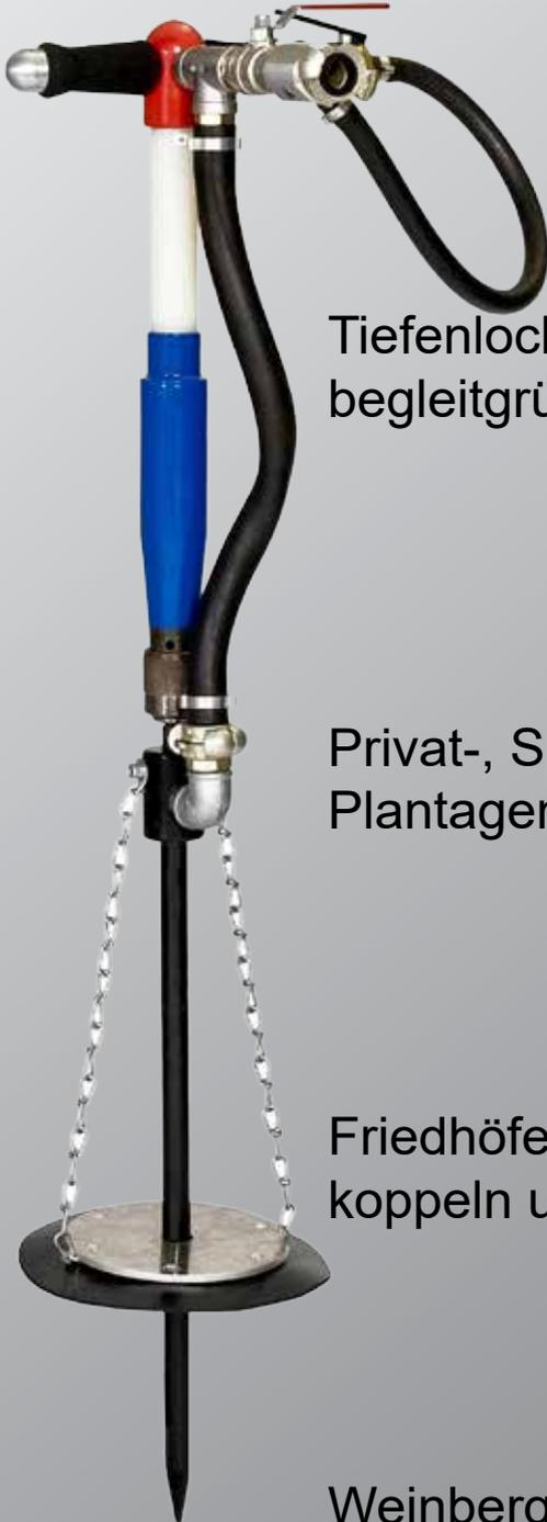
Die Bodeninjektionsgeräte Der MTM Spindler & Schmid GmbH sind Spezialwerkzeuge für die allgemeine Standortverbesserung oberirdischer Vegetation. Mit ihnen können Luft, Wasser und Nährstoffe in den Boden eingebracht werden und dadurch die Wachstumsbedingungen für Bäume und Sträucher verbessert werden. Durch Druckluft werden Nährstoffe wieder Verfügbar, Tagwasser kann abfließen und der Austausch zwischen atmosphärischer Luft und Bodenluft wird nachhaltig verbessert.
