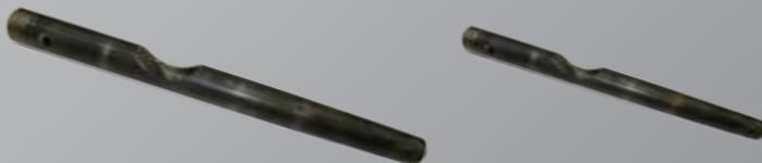
Bestimmte Bodenverhältnisse lassen kein einfaches Einrammen von Pfosten zu, besonders Holzpfähle haben die Eigenschaft bei steinigem Untergrund zu splintern. Um auch bei steinigem und durchsetztem Untergrund gute Ergebnisse zu erzielen kann ein Locheisen zum Einsatz kommen, das Steineinlagerungen verdrängt, oder durchschlägt und deren Reste durch die Auswurföffnung nach oben fördert, so dass auch bei problematischem Untergrund Pfähle gesetzt werden können.
