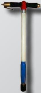
Der T-Griff eignet sich hervorragend um Fundamentlöcher auszuheben, oder in Kombination mit einer Stampferplatte als Kleinflächenverdichter. Im Sanierungsbereich eignet er sich besonders für die Entfernung von zähen Bodenbelägen.
