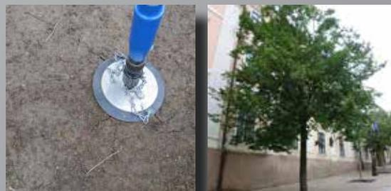
Der Terramat ist in der Lage ohne langwierigen Umrüstprozess sowohl Flüssigkeiten als auch Feststoffe in einem Arbeitsgang einzubringen. Durch die Steuereinheit an der Injektionslanze kann wahlweise Luft- oder Wasserförderung angesteuert werden. Wasser kann das Erdreich aufbrechen, feste Nährstoffe oder Stützkorn können sofort eingebracht werden.
